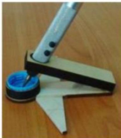
Рисунок 6. Подставка под диагностический электрод
