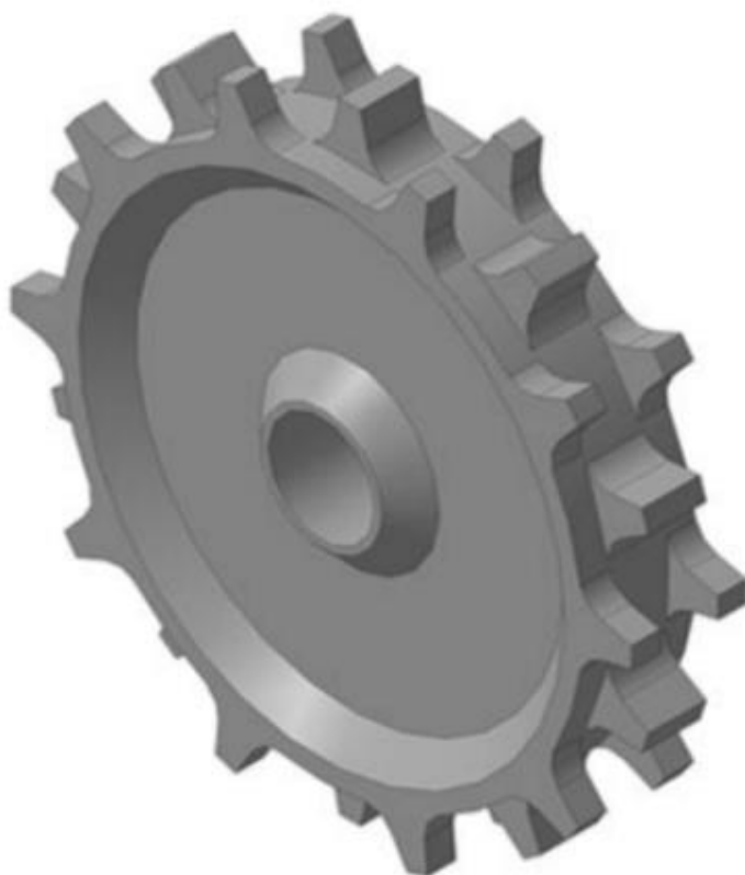
Рисунок 3. Звездочка для предлагаемой цепи по варианту 1
